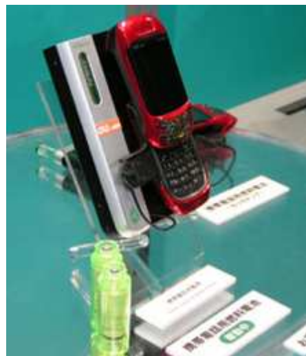
日立製作所の展示。携帯電話機用燃料電池充電器と燃料カートリッジ
