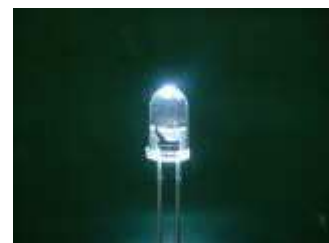
砲弾型LED: 照明にはこのような素子を平面に複数並べて使用する(トリコン社のHPより)
