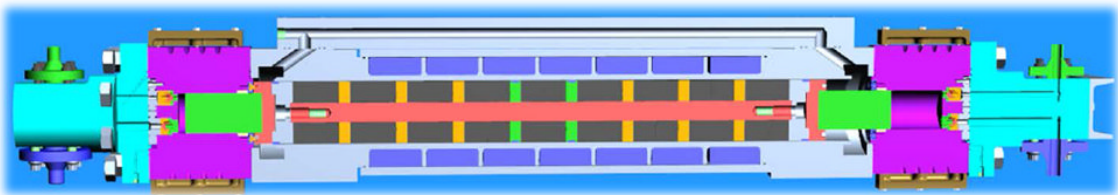
図 3. リニアモータ駆動のレシプロ水素コンプレッサ
